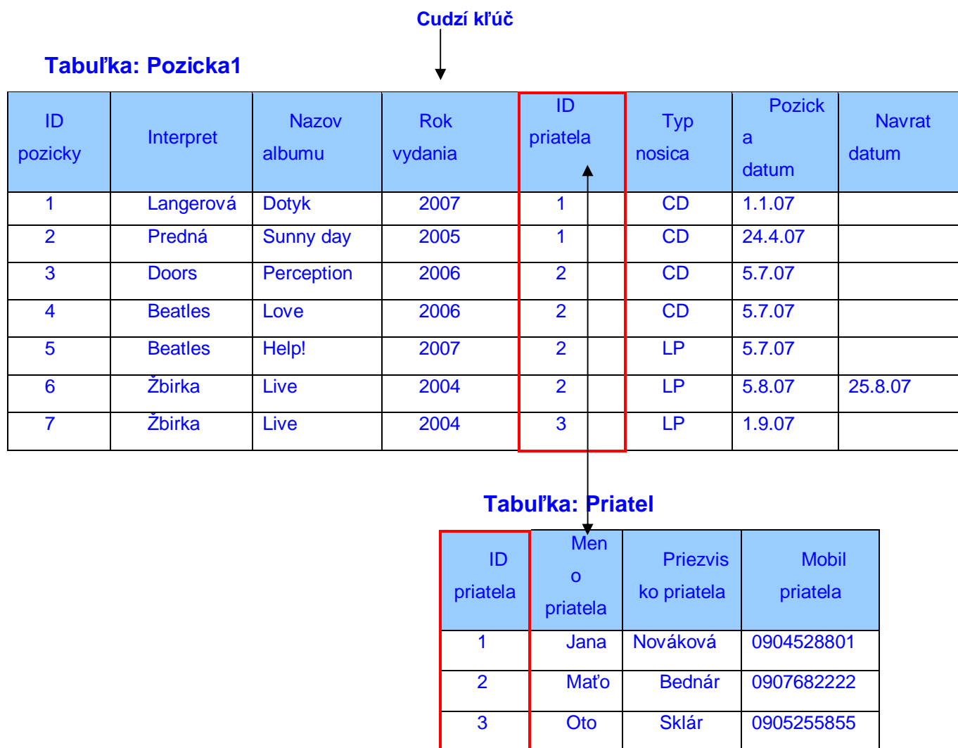
Obr. Znáozornenie väzby medzi tabuľkami „Pozicka1“ a „Priatel“. Atribút ID priatela je cudzím kľúčom tabuľky „Pozicka1“.
