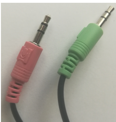
Obrázek 11.1: Ukázka dvou jack konektorů od sluchátek s mikrofónem, kdy zelený je pro sluchátka a růžový je pro mikrofón.
